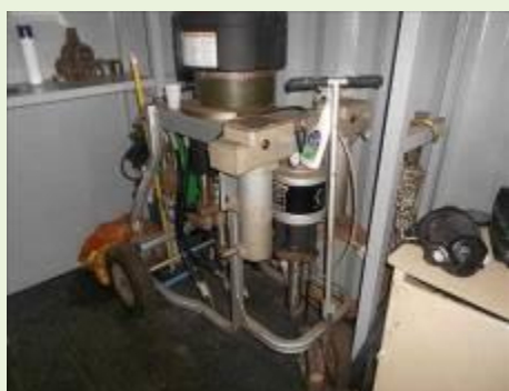
PULVERIZADOR E MISTURADOR MARCA GRACO MOD.XP-70 PARA PINTURA SERIE L12B PART| Item: 100551 |
