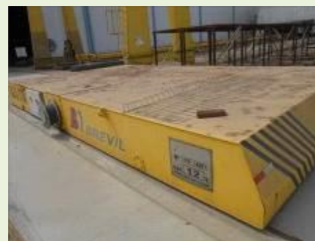
VAGONETA EM AÇO MOTORIZADA MARCA BREVIL NR.406/2007 CAP.12T. DIM.3,50X8,00M | Item: 500201 |
