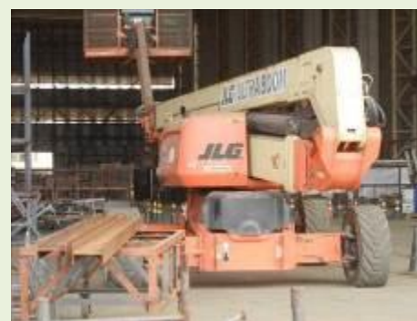
PLATAFORMA ELEVATÓRIA AUTOPROPELIDA MARCA JLG MOD.1250AJP SERIE 0300149363 CAP. MAX. 1.000LBS (PTA-001) | Item: 295613 |
