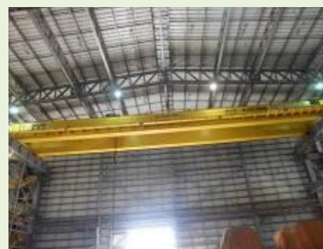
PONTE ROLANTE BIVIGA MARCA TERTECMAN CAP. 30T. VÃO 40X10M ALTURA COM ELETROIMÃ (70PRT003) | Item: 510233 |
