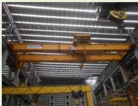
PONTE ROLANTE BIVIGA MARCA ANUPAM COD.KIF2060B CAP.150T | Item: 305691 |
