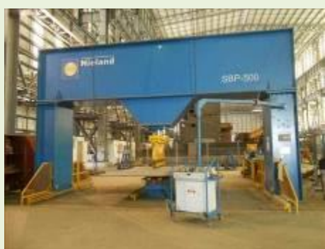
PRENSA DOBRADIEIRA HIDRAULICA MARCA NIELAND TIPO SBP-500/7000 NR.1206-00047 CAP.5.000KN (70PNS001) | Item: 510238 |
