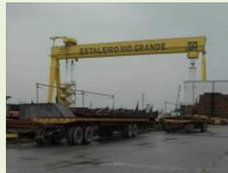
PÓRTICO ROLANTE AUTOPROPULSADO SOBRE TRILHOS MARCA KRONE CRANES | Item: 148524 |
