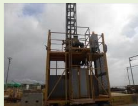
ELEVADOR CREMALHEIRA MARCA PINGON MOD.EP18 CAPACIDADE 18 PESSOAS/ 1500 KILOS. ALTURA FINAL 106,50MM. (NÃO ESTÁ INSTALADO) | Item: 310850 |
