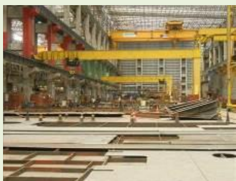
SEMI PÓRTICO ROLANTE MARCA TRUCKFORT OF.10/1078D CAP.15T. VÃO 22X4,3M ALTURA (24SPT001) | Item: 510214 |
