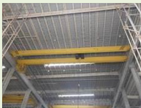
PONTE ROLANTE BIVIGA MARCA BREVIL NR.371/06 CAP.20 TON VÃO 30X25M ALTURA COM COMANDO CABINE (PR-11) | Item: 510105 |
