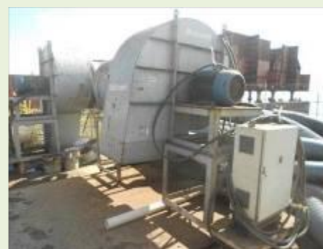
EXAUSTORES MARCA MOTOVENT MOD.CLLD-825-4 VAZÃO 834M3/MIN. COM MOTOR 50CV | Item: 100272 |
