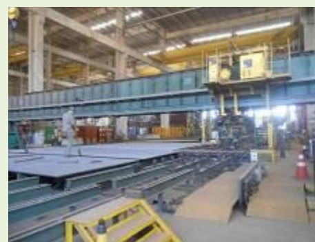
LINHA FABRICAÇÃO PAINÉIS MARCA OGDEN | Item: 316657 |
