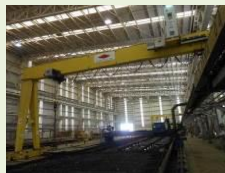
SEMI PÓRTICO ROLANTE MARCA TRUCKFORT OF.10/1078J CAP.5T. VÃO 12,5X5,0M ALTURA (21SPT001) | Item: 510228 |
