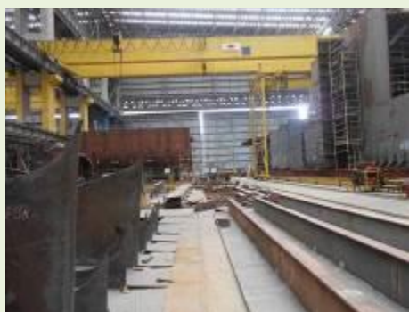
PONTE ROLANTE BIVIGA MARCA TRUCKFORT OF.10/1078B VÃO 44X13,3M ALTURA CAP.30T. COMANDO CONTROLE REMOTO, COM ELETROIMA DE 15T. (23PR003) | Item: 305653 |
