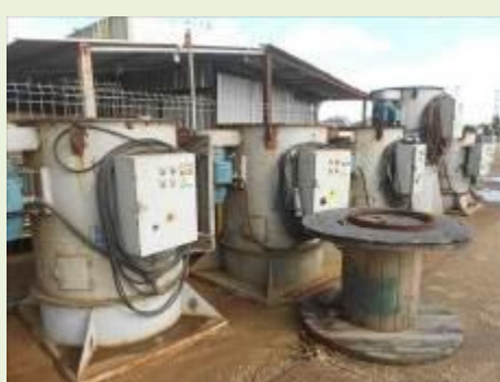
EXAUSTORES AXIAIS MARCA BRANDT VAZÃO 60.000M3/H, PRESSÃO 92M/M CA COM MOTOR 25CV | Item: 100262 |
