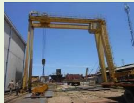
PORTICO ROLANTE BIVIGA MARCA BREVIL NR.484/08 CAP.16 TON VÃO 14X12M ALTURA COM COMANDO CABINE (PRT-03) | Item: 510112 |
