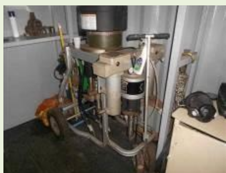
PULVERIZADOR E MISTURADOR MARCA GRACO MOD.XP-70 PARA PINTURA SERIE L12B PART,NR.571302 | Item: 100551 |
