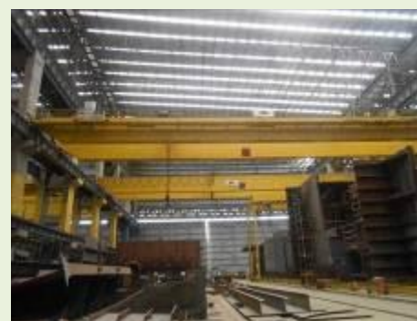
PONTE ROLANTE BIVIGA MARCA TRUCKFORT OF.10/1078B VÃO 44X13,3M ALTURA CAP.30T. COMANDO CONTROLE REMOTO, COM ELETROIMA DE 15T. (23PR002) | Item: 305652 |
