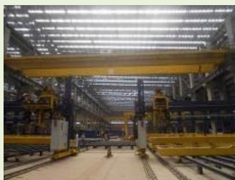
PONTE ROLANTE BIVIGA MARCA TRUCKFORT OF.10/1078B VÃO 44X13,3M ALTURA CAP.30T. COMANDO CONTROLE REMOTO, CAP (22PR002) | Item: 294612 |
