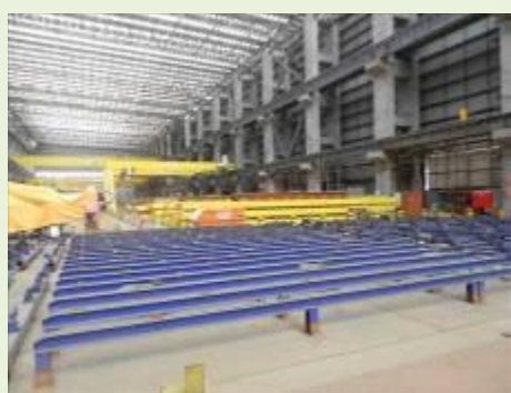
CROSS TRANSPORT AREA (TRANSPORTADOR DE ROLDANAS) MARCA IMG SERIE K7539.50CTA LARGURA 14X8M | Item: 100529 |
