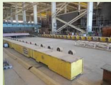
LOAD-OUT SISTEMA PARA DESLOCAMENTO HORIZONTAL E IÇAMENTO DE BLOCOS E MÓDULOS MARCA OGDEN DIM.9X15M ELEVÇÃO 2M COM MESA DE COMANDO MCE-01 (LDT-01) | Item: 100001 |
