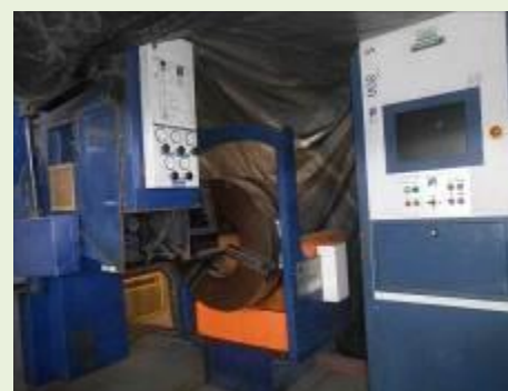
LOTE DE 3 MAQUINAS P/ CORTE DE TUBOS MARCA HGG TIPO SPC-800 SERIE 115107 DIAMETRO TUBO 48MM - 810MM PESO MAX.TUBO 6T. | Item: 500076 |
