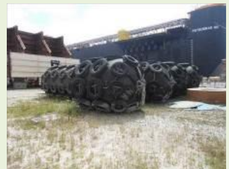
DEFENSER TIPO BOIA MARCA YOKOHAMA MOD 2,5 DX 4,0 L ( 25X40-50-IOFM25) DIM 3,00 M DIAM 2,50 M | Item: 200027 |
