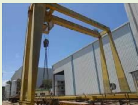
PORTICO ROLANTE BIVIGA MARCA BREVIL NR.361/06 CAP.16 TON VÃO 14X12M ALTURA COM COMANDO CABINE (PRT-02) | Item: 510108 |
