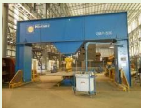
PRENSA DOBRADEIRA HIDRAULICA MARCA NIELAND TIPO SBP-500/7000 NR.1206-00047 CAP.5.000KN (70PNS001) | Item: 510238 |
