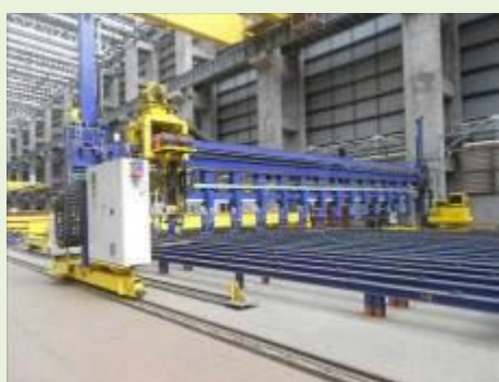
STIFFENER MOUNTING GANTRY (PORTICO PARA MONTAGEM PERFIS) MARCA IMG SERIE K7539.23/280.984 VÃO 18M PESO 19T. COM 14 BICOS DE SOLDA (22SW001) | Item: 100522 |
