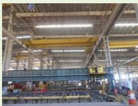
PONTE ROLANTE BIVIGA MARCA BREVIL NR.366/06 CAP.16 TON VÃO 18X8M ALTURA COM COMANDO CABINE (PR-07) | Item: 510113 |
