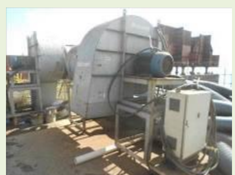
EXAUSTORES MARCA MOTOVENT MOD.CLLD-825-4 VAZÃO 834M3/MIN. COM MOTOR 50CV | Item: 100272 |
