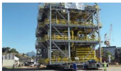
Integração de módulos de plataformas e navios
