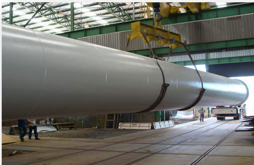
Corpo de uma torre eólica típica
