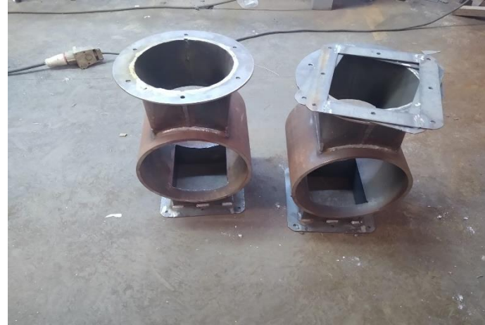
Válvulas de saída do ciclone.
