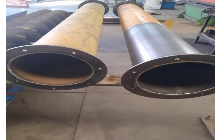
Tubulação entrada ciclone.
